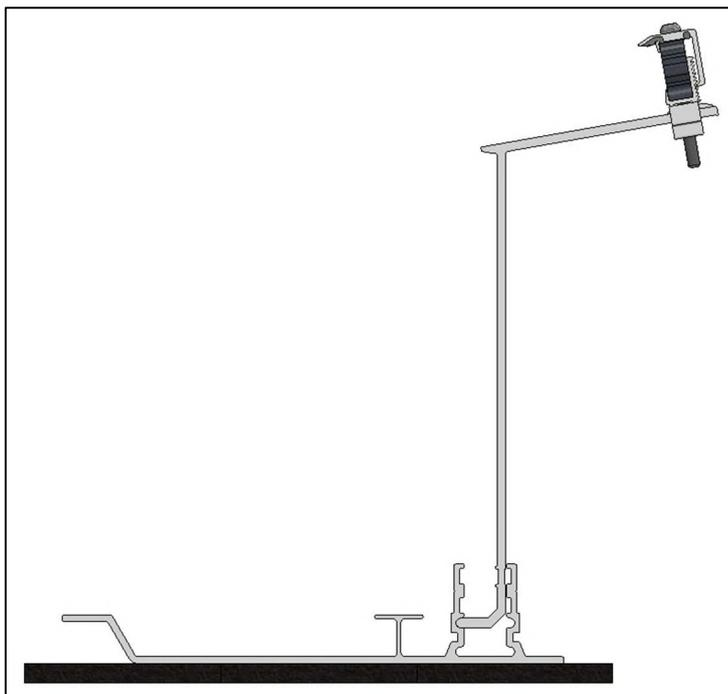
El pie trasero montado ahora se puede colocar debajo del lado alto del panel y la abrazadera se puede fijar al marco del panel. El pie delantero se puede fijar al marco del panel en el lado inferior del panel.
