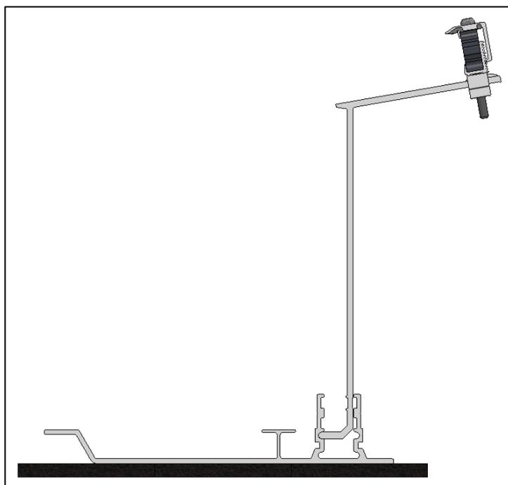
Il piede posteriore montato può ora essere posizionato sotto il lato alto del pannello e il morsetto può essere fissato al telaio del pannello. Il piede anteriore può essere fissato al telaio del pannello sul lato inferiore del pannello.
