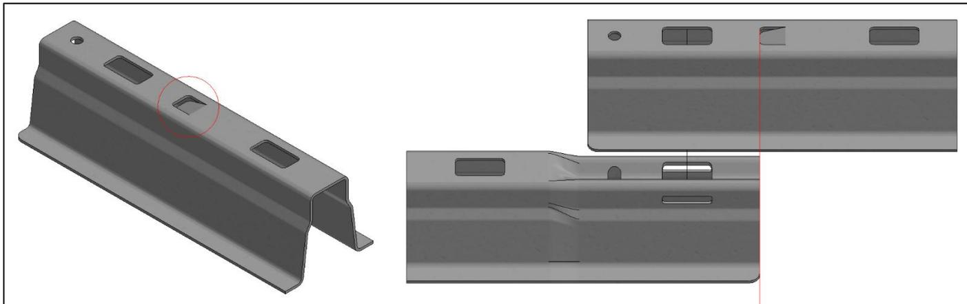
Il lato non rastremato di ciascuna guida di montaggio è dotato di un labbro che può essere utilizzato come fermo per l'allineamento. Il lato conico del profilo può essere spinto verso l'arresto. In questo modo si garantisce il corretto allineamento delle guide di montaggio.
