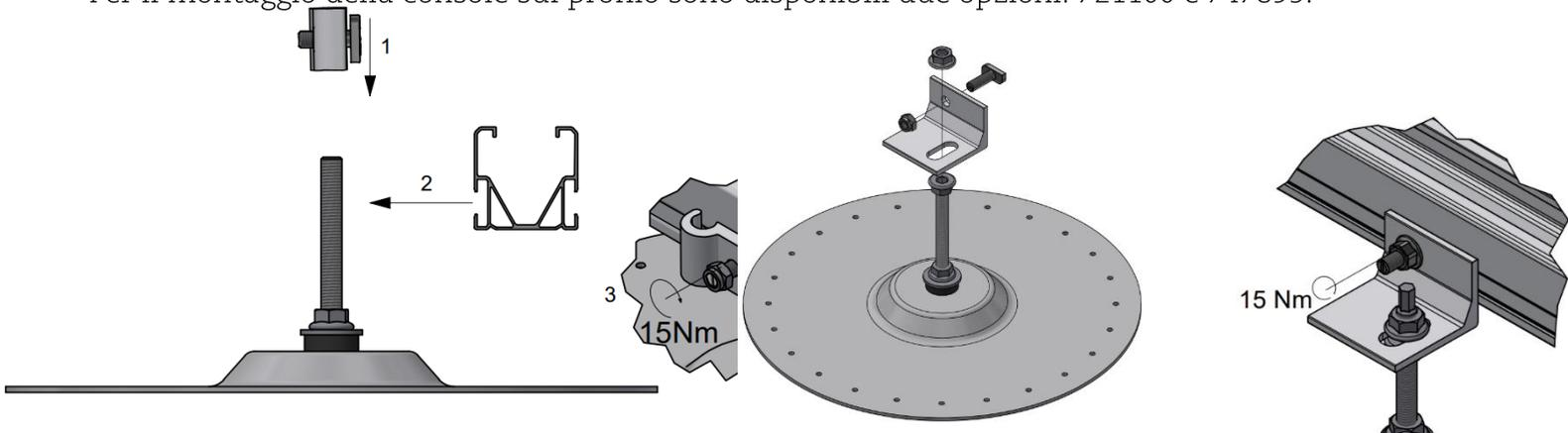
Il vantaggio rispetto al fissaggio al portapacchi è che il fissaggio può essere installato successivamente. Ciò consente una maggiore flessibilità durante i lavori di installazione. Si noti, tuttavia, che le forze massime del fissaggio sono inferiori.
