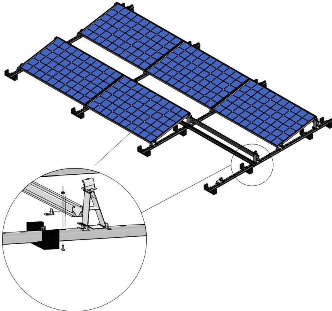
Quando si monta il morsetto del bullone di sospensione (721100), è importante lasciare almeno 1 mm di filettatura sopra il morsetto.
