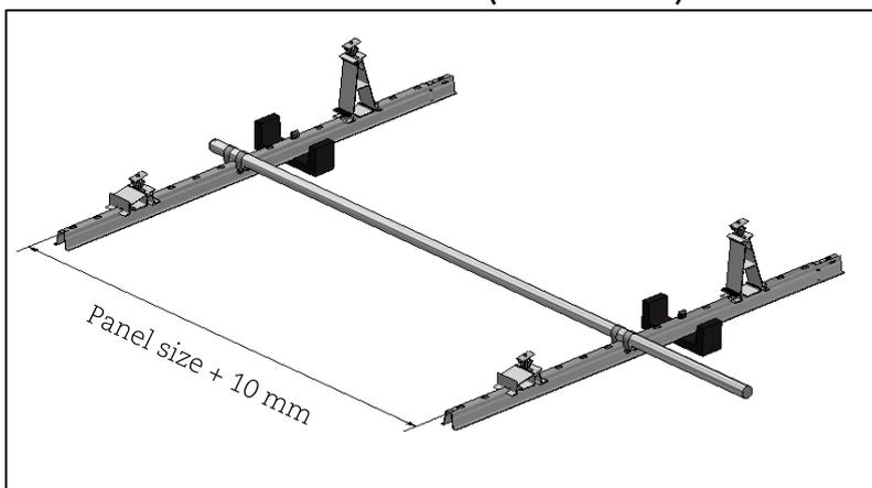
Il set di allineamento può essere utilizzato per assicurarsi che le file di portanti del tetto siano posizionate con il passo corretto.
