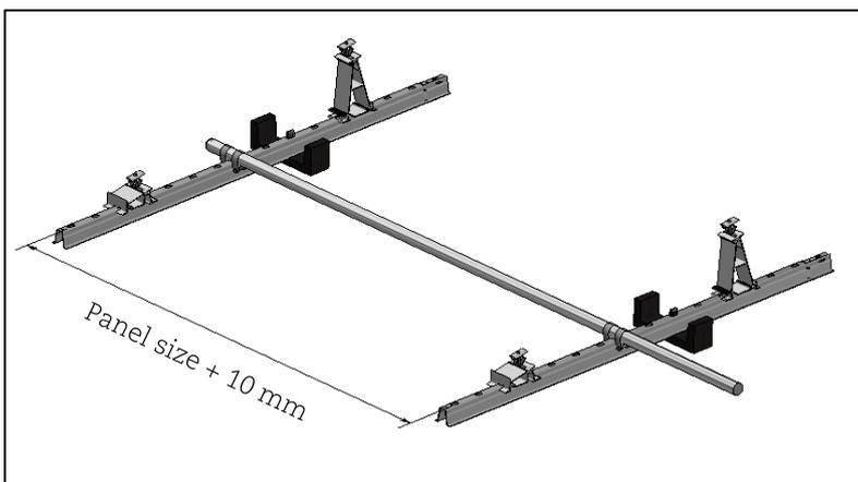
Le kit d'alignement peut être utilisé pour s'assurer que les rangées de profilés soient placées à la bonne inclinaison.
