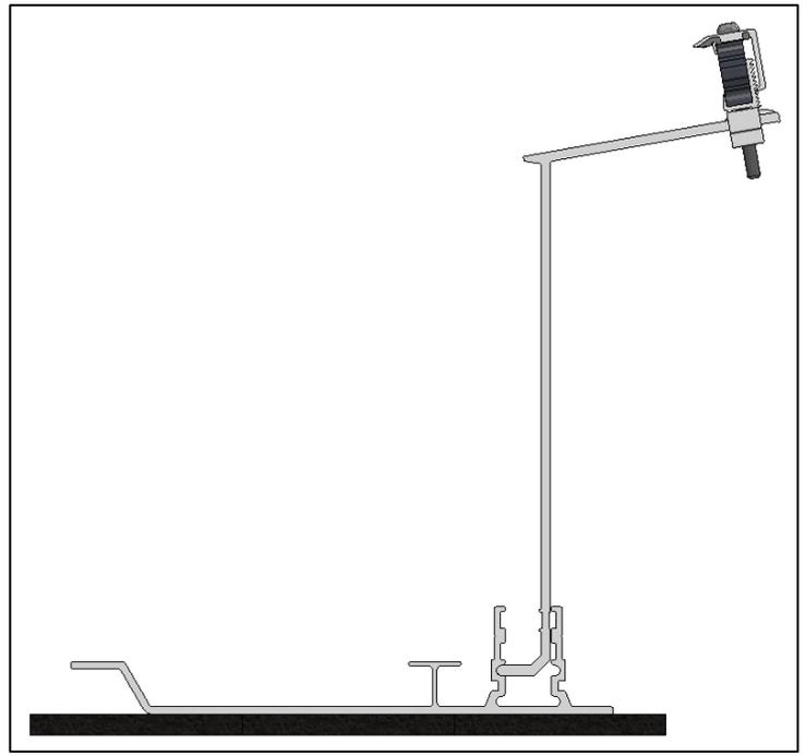
Le pied arrière monté peut maintenant être placé sous le côté haut du panneau et la pince peut être fixée au cadre du panneau. Le pied avant peut être fixé au cadre du panneau sur le côté bas du panneau.
