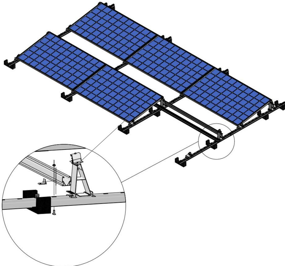
les supports de toit sur le côté du profilé Side++. Le support est accroché dans la chambre à tête de marteau du profilé Side++, créant ainsi une connexion.
