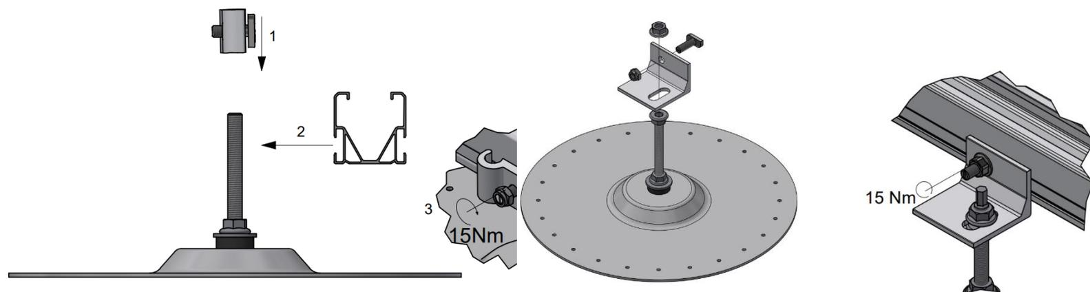
L'avantage par rapport à la fixation sur les profilés est que la fixation peut être installée ultérieurement. Cela permet une plus grande flexibilité lors des travaux d'installation. Veuillez toutefois noter que les forces maximales de la fixation sont plus faibles.
