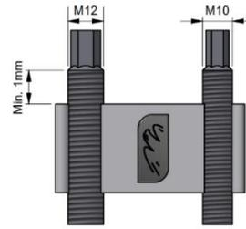
Les profilés en aluminium sont montés sur la console à l'aide des boulons à tête marteau. Les boulons à tête marteau sont placés dans les fentes des profilés. Lorsque tous les boulons sont placés dans le profilé, tout est fixé avec l'écrou du crochet de toit. (le couple de serrage maximal est de 15 Nm).
