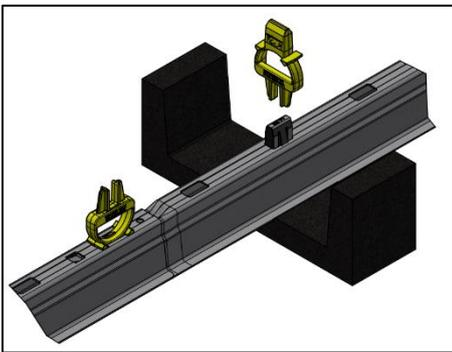
La clé d'alignement permet d'aligner les rainures superposées des profilés
