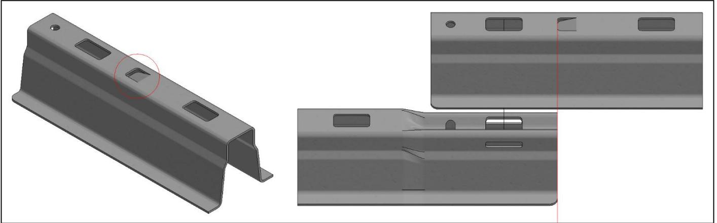
Le côté lisse de chaque profilé est doté d'une lèvre qui peut être utilisée comme butée pour l'alignement lors de l'accouplement des profilés. L'extrémité conique du profilé peut être poussée contre la butée. Cela garantit que les profilés sont correctement alignés.
