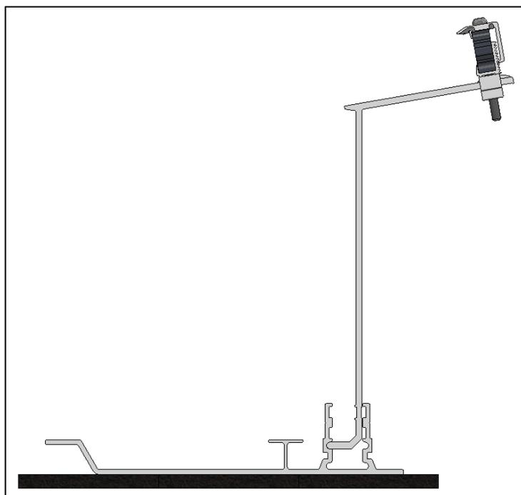
Die montierte hintere Modulstütze kann nun unter der hohen Seite des Moduls platziert und die Klemme am Modulrahmen befestigt werden. Die vordere Modulstütze kann auf der unteren Seite des Moduls am Modulrahmen befestigt werden.
